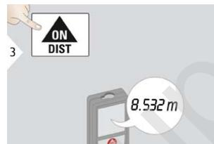
**i** Superfici target: se si misura la distanza da liquidi incolore, vetro, polistirolo o superfici permeabili o si punta su superfici molto lucide possono verificarsi errori di misura. Se si punta su
