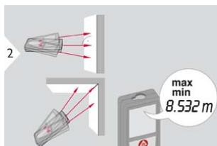
Consente di misurare le diagonali delle stanze (valori massimi) o le distanze orizzontali (valori minimi). Viene indicata sul display la distanza minima e massima misurata (min., max.). L'ultimo valore misurato compare nella riga principale.
