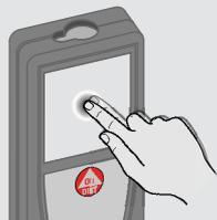
Toccare una volta il display per aprire un pulsante a video o eseguire una selezione. Toccando l'icona posta al centro della riga in basso si attiva la misura della distanza o la fotocamera.
